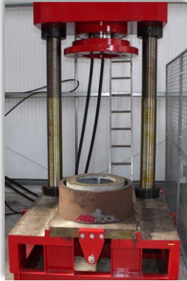
Defekte Laufradfläche wird mit einer 150t- Presse vom Rad getrennt
