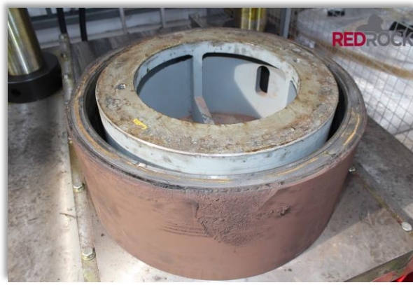
Defekte Laufradfläche wird mit einer 150t- Presse vom Rad getrennt
